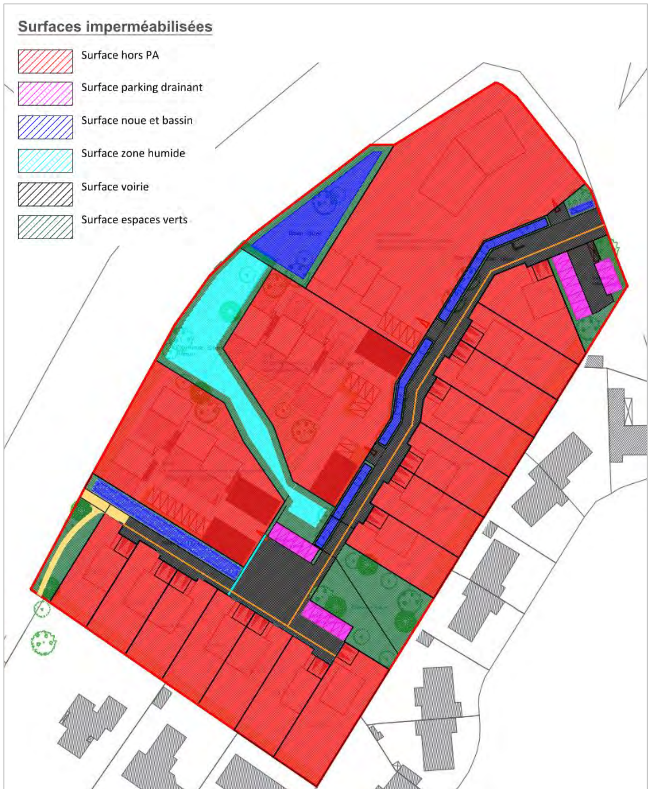
Figure 5 : Plan de répartition des surfaces (Source : SODEREF)
