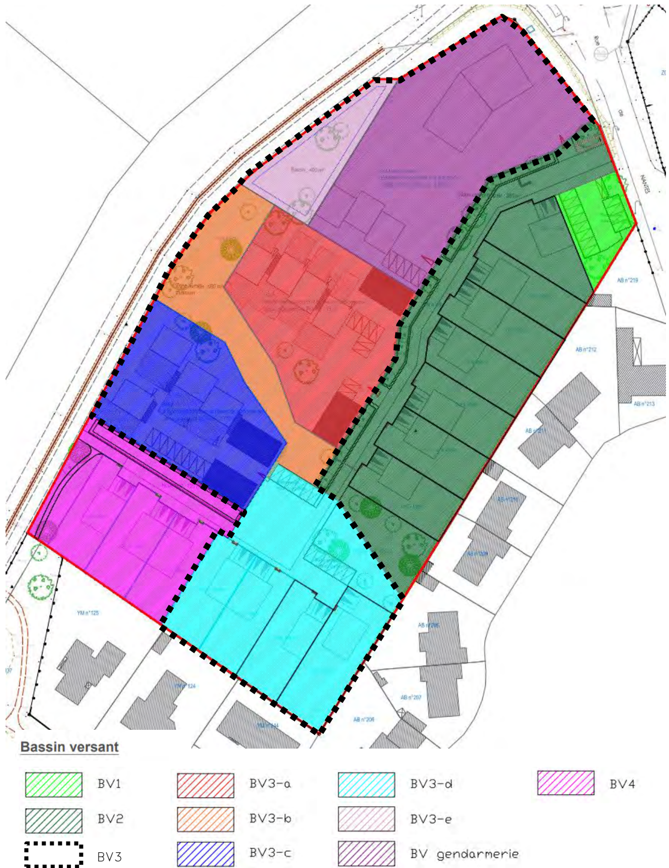
Figure 4 : Plan de décomposition de l'opération en bassins versants (Source : SODEREF)
